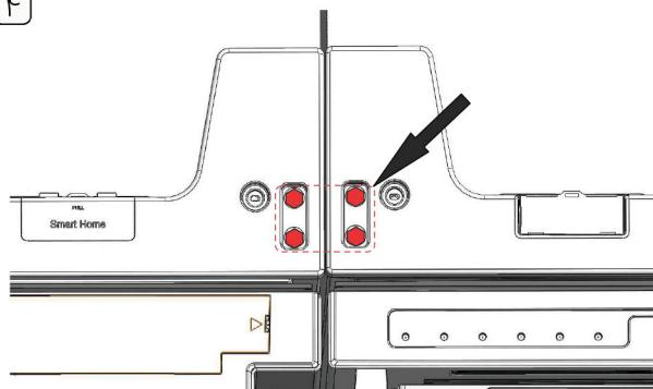
۵- حال بایستی بست اتصال پایین را مونتاژ نمایید. بدین منظور ابتدا پیچ های نشان داده در شکل پایین را باز کنید، سپس بست اتصال پایین را توسط پیچ های باز شده در مرحله قبل به محصول متصل نمایید تا از پایین، یخچال و فریزر را به یکدیگر متصل نماید.
