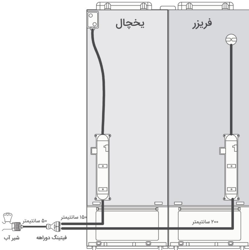
دستورالعمل نصب سریع اتصالات یخساز و آبسردکن
